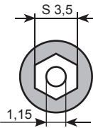
Wkręt kaniulowany samogwintujący Ø5,0 Cannulated self-tapping screw Ø5.0 Канюлированный самонарезающий винт Ø5,0
